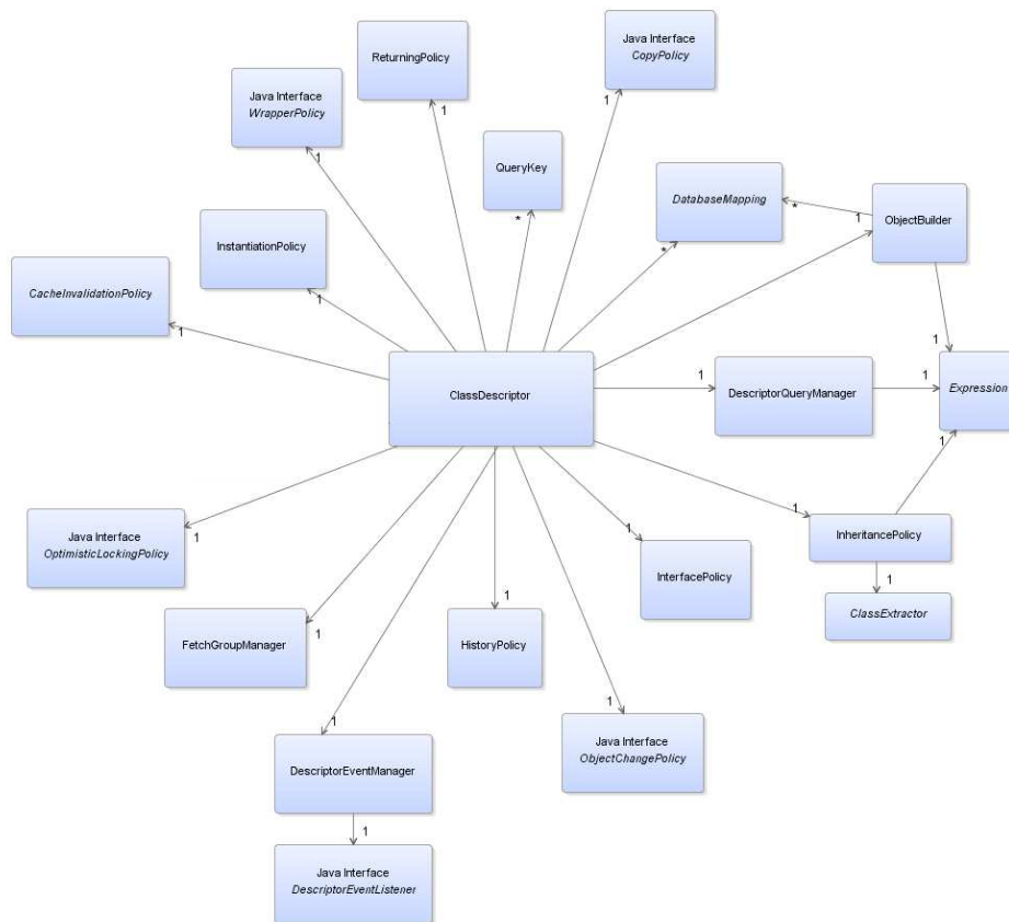
Abbildung 4.12: Kern der Entity-Metadaten Repräsentation in EclipseLink. (Quelle: EclipseLink Dokumentation [31])
