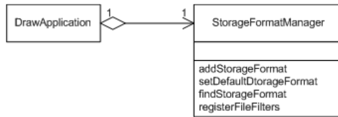
Abbildung 33: Beziehung zwischen den Klassen DrawApplication und StorageFormatManager , objektorientiert
